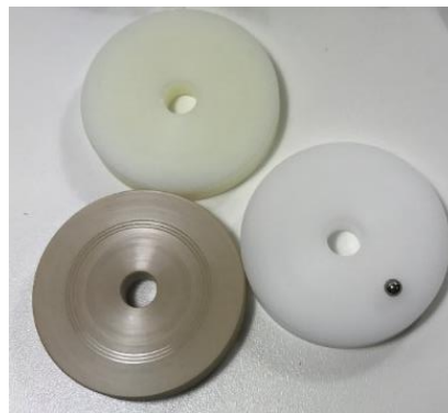
Abbildung 2: Für das PET gefertigte Materialproben POM, PEEK, PA
